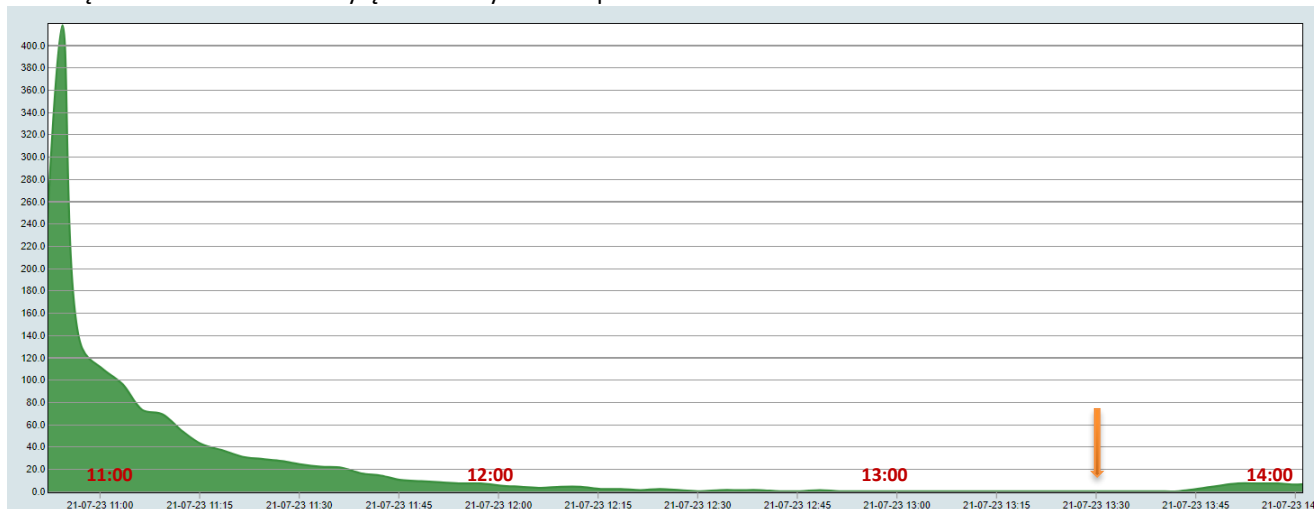
Wykres 26. Stężenie pyłów frakcji PM 1 w powietrzu – test obciążeniowy w sali o kubaturze 230m 3 – Sensor 2. Strzałką zaznaczono moment wyłączenia oczyszczacza powietrza
