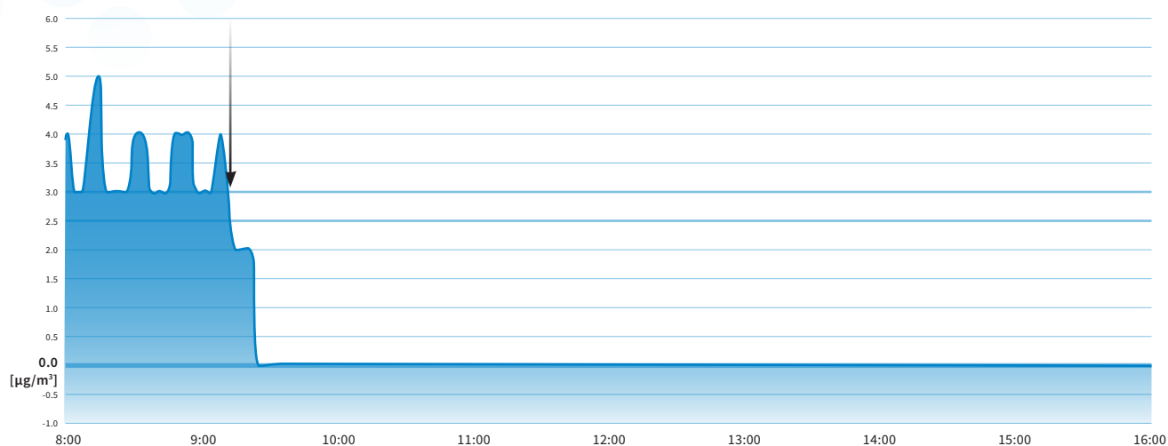
Wykres 1. Stężenie pyłów frakcji PM2.5 w powietrzu w pomieszczeniu o kubaturze 100m 3 – Sensor 2. Strzałką zaznaczono moment uruchomienia oczyszczacza powietrza
