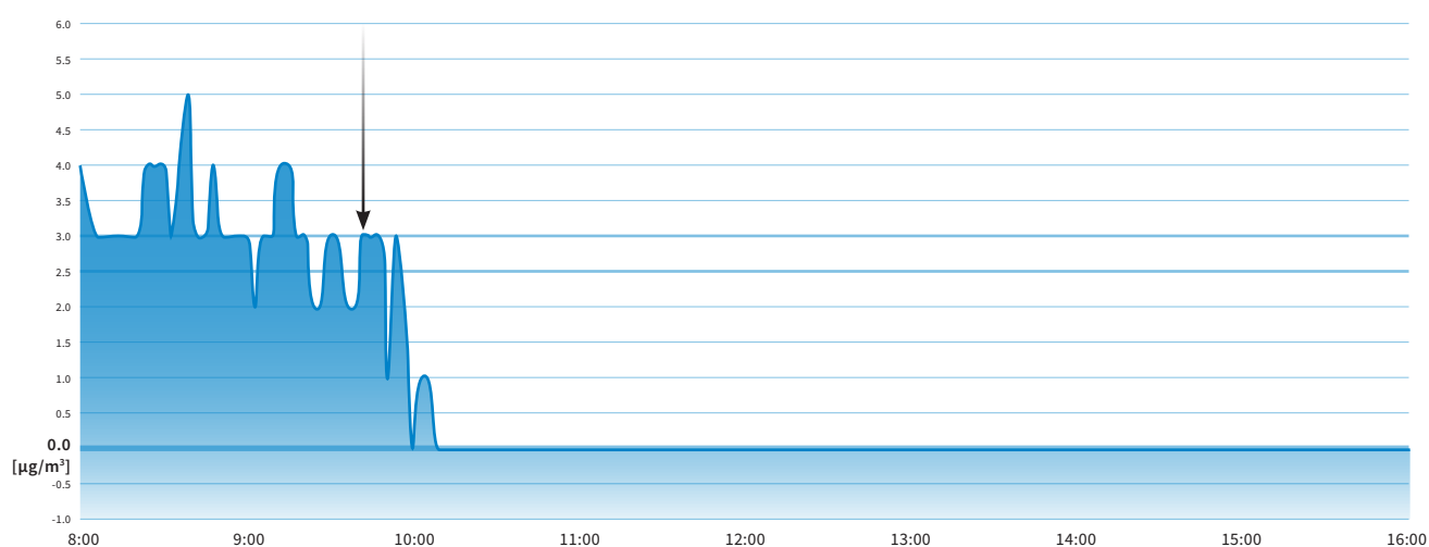
Wykres 2. Stężenie pyłów frakcji PM2.5 w powietrzu w pomieszczeniu o kubaturze 230m 3 – Sensor 3. Strzałką zaznaczono moment uruchomienia oczyszczacza powietrza
